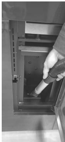
Fig. 35 - Reinigung Fach Brennschale
