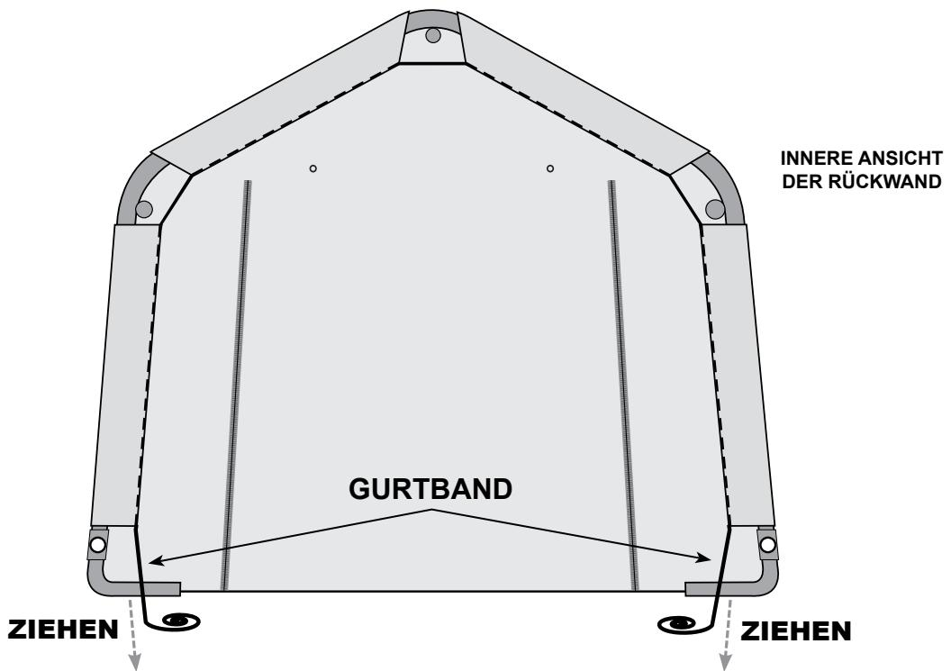
E. Führen Sie den "S"-Haken an der Ratsche in das Loch an dem Gestellfuß. Anschließend schieben Sie das Gurtband durch die Ratsche. Achten Sie darauf, dass die Vorder- und Rückwand mittig angebracht ist.
