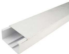
Zur Verlegung elektrischer Leitungen Dient dem Schutz und der mechanischen Entlastung von Leitungen Material: PVC, schwer entflammbar, selbst verlöschend Unterteil mit regelmäßiger Bodenlochung Mit Deckel Maße: 60x110mm Temperaturbereich: 5°C bis +60°C
