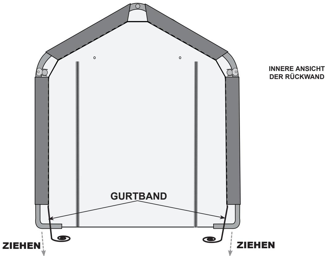
E. Führen Sie den "S"-Haken an der Ratsche in das Loch an dem Gestellfuß. Anschließend schieben Sie das Gurtband durch die Ratsche. Achten Sie darauf, dass die Vorder- und Rückwand mittig angebracht ist.
