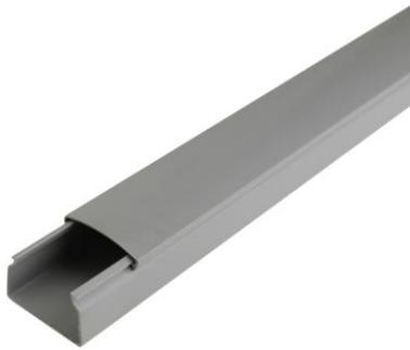
Zur Verlegung elektrischer Leitungen Dient dem Schutz und der mechanischen Entlastung von Leitungen Material: PVC, schwer entflammbar, selbst verlöschend Unterteil mit regelmäßiger Bodenlochung Mit Deckel Maße: 30x30mm Temperaturbereich: 5°C bis +60°C
